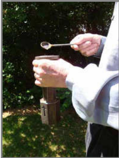
Schwarzpulver und Dämmung eingeben
