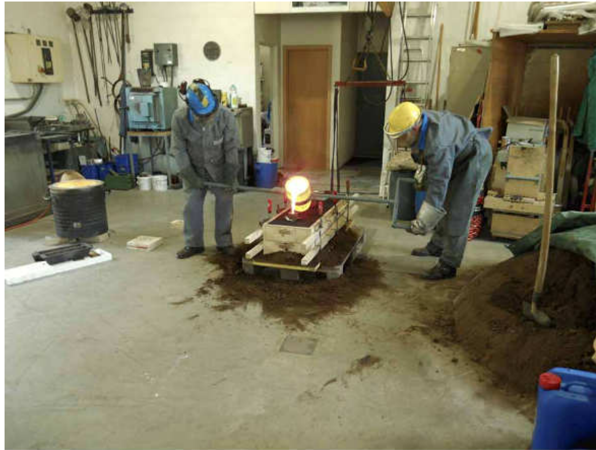
Sorgfältiges Giessen der flüssigen Bronze in die Giessform
